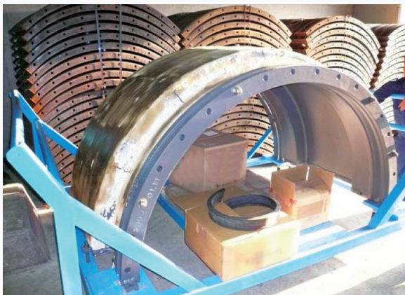
写真7 施設内に備蓄している大口径管カバージョイント
