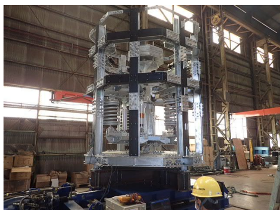
制振装置の工場製作・調整状況
