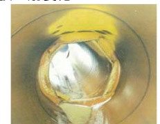
断層変位による水道鋼管の座屈※3 →復旧資材の備蓄と他系統への切替え
