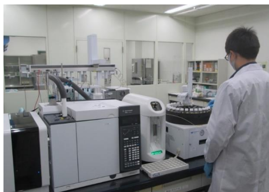
写真 5 広域水質管理センターにおける水質分析作業 (ガスクロマトグラフ質量分析装置)
