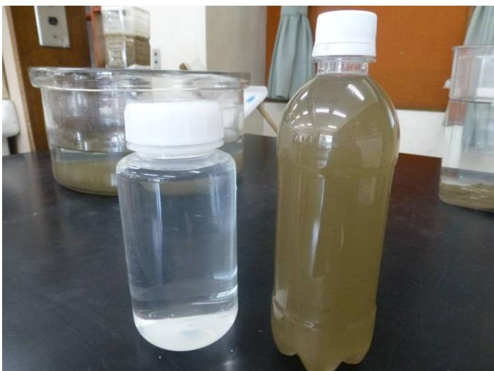
右側が浄水処理していないにごり水で、左側が凝集→沈でん→ろ過の3ステップで浄水した水です。
