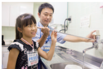
音聴棒を使って漏水調査を体験。音の違いで漏水箇所がわかる(上)。企業団が備蓄している6リットル入りの給水袋。簡単に組み立てることができる(右)
