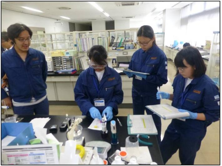
そして、実際に残塩の実測に挑戦！マニュアルを見ながら薬品を入れ、数値が出たら表に記入していきます。最後に 3 人の実測した値の平均値と、計器の数値がずれていないかチェックします。
