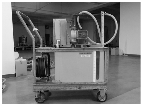
写真1 PAC仮設注入機
